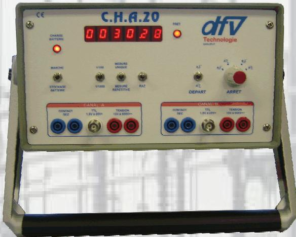
Chronom tre permettant de v rifier le temps entre deux impulsions g n r es par un contact sec, par un niveau TTL ou par une tension continue / alternative. Il est indispensable pour v rifier les relais des protections et disjoncteurs dans les postes sources. Mesure des temps de commutation des relais (d lai "commande/contact")
